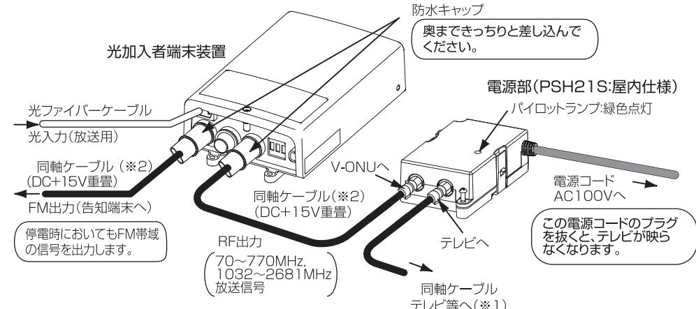
※1 テレビ、チューナー、HDDレコーダー等のCS/BSアンテナ電源を必ず「供給しない」または「OFF」に設定してください。
